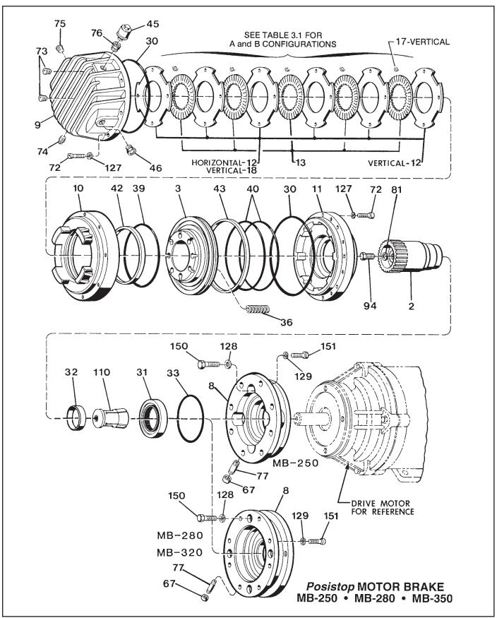
Figure 8.2 MOTOR BRAKE EXPLODE
