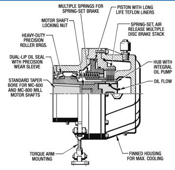
MB-320 MOTOR BRAKE SHOWN FOR MC-806 FRAME MILL MOTOR
