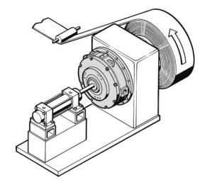
B Shaftless Unwind Stand (Paper Converting Mill)
